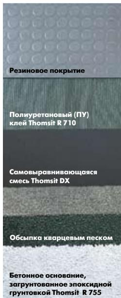
Полы в промышленных и коммерческих зданиях неизбежно подвергаются высокому механическому нагрузкам. В этом случае часто используются каучуковые покрытия. Но эти покрытия будут работать успешно только тогда, когда основание отвечает соответствующим требованиям. Система устройства промышленного пола Thomsit обеспечивает надежную укладку каучукового покрытия на основание, в т. ч. с повышенной остаточной влажностью.
