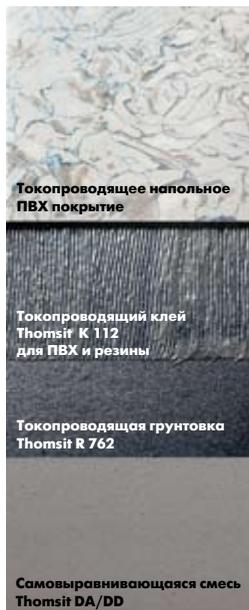
В операционных и других медицинских помещениях существуют особые требования к безопасности. Электрический разряд способен привести к сбою в работе сложного оборудования. Специально для таких помещений разработаны токопроводящие системы.
