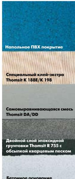
Строительные нормы не позволяют производить укладку покрытий на влажные основания. Блокирование капиллярной влаги в бетонных и цементно-песчаных основаниях достигается способом, доказавшим свою эффективность в течение десятилетий: барьерный слой выполняется из 2-компонентной эпоксидной грунтовки Thomsit R 755.
