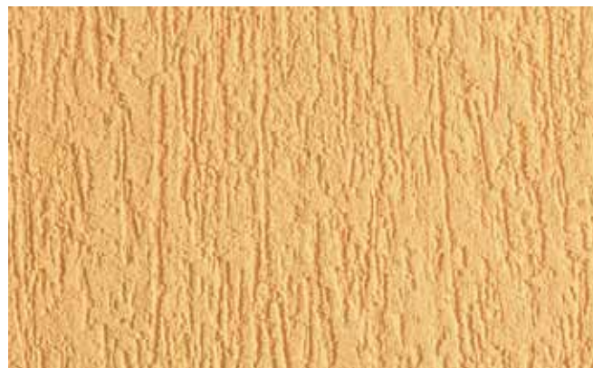
Штукатурка Ceresit CT 35, зерно 3,5 мм, получена путем затираний пластиковым полутерком (теркой) в одном направлении.
