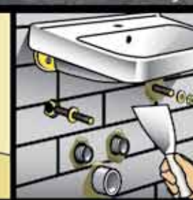
МОНТАЖ САНТЕХНИЧЕСКОГО ОБОРУДОВАНИЯ
