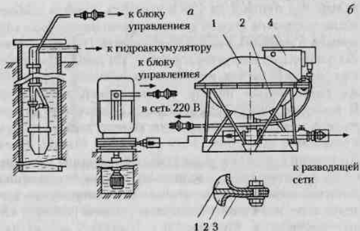
Рис. 57. Гидропневматическая водоподъемная установка: а — погружной насос в колодезце или скважине; б — гидроаккумулятор; 1 — водяная камера; 2 — воздушная камера; 3 — мембрана; 4 — блок управления.
