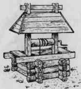
Рис. 32. Надземная часть деревянного колодца.
